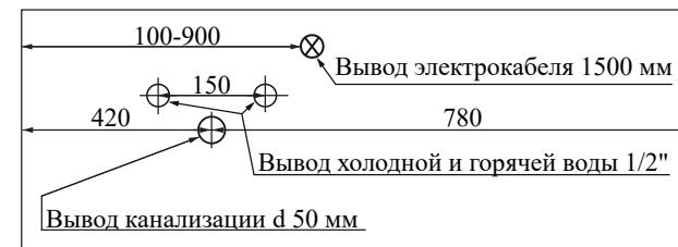
Вывод горячей и холодной воды, устанавливаются угловые шаровые краны
