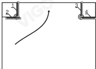
**1 и 3** - расстояния от крепёжных отверстий до края зеркала по вертикали
