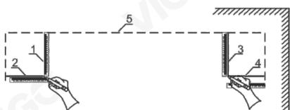
**1 и 3** - расстояния от крепёжных отверстий до края зеркала по вертикали
