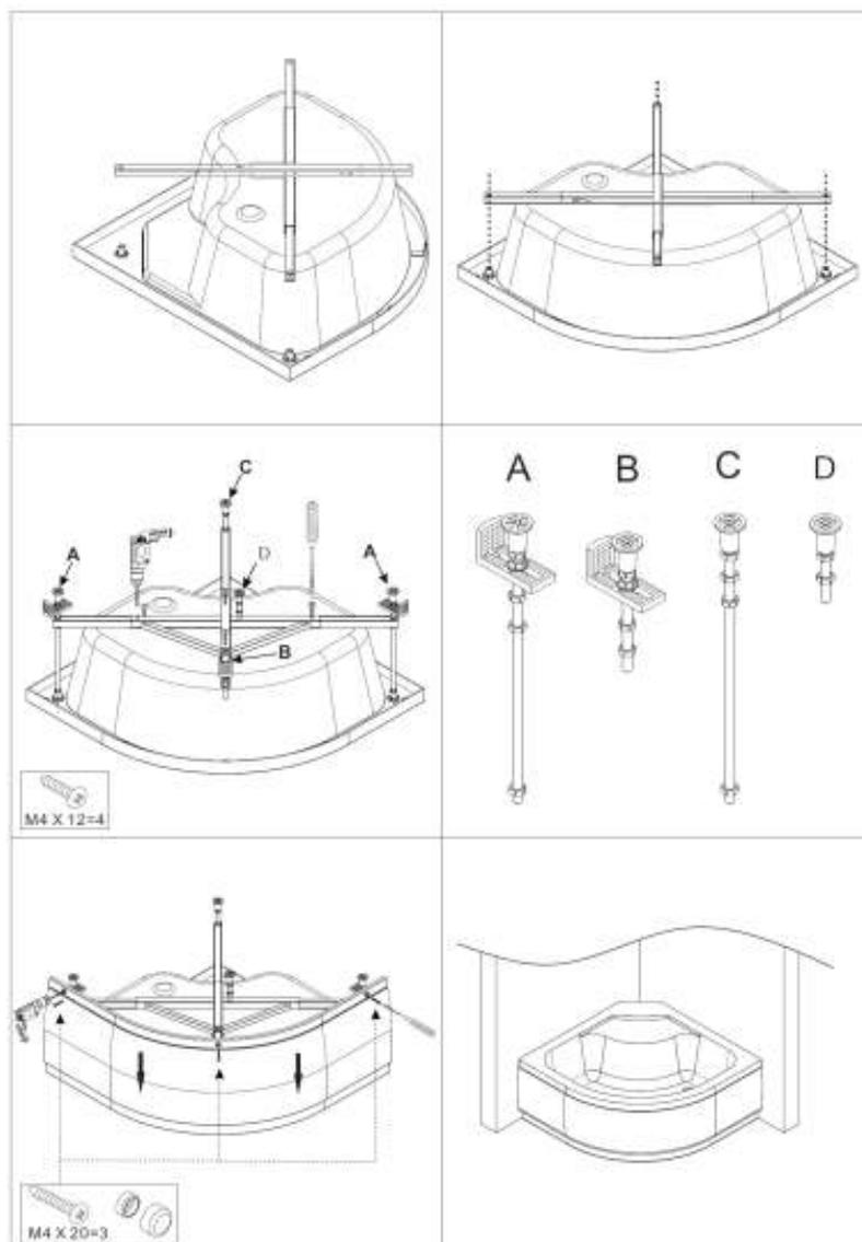
Поддон с каркасом частично собран, необходимо установить все остальные части предлагающиеся для сборки и затянуть ключом все винтовые соединения. Ножки служат для выставления поддона по уровню, поэтому под несущую конструкцию необходимо установить дополнительные упоры.
