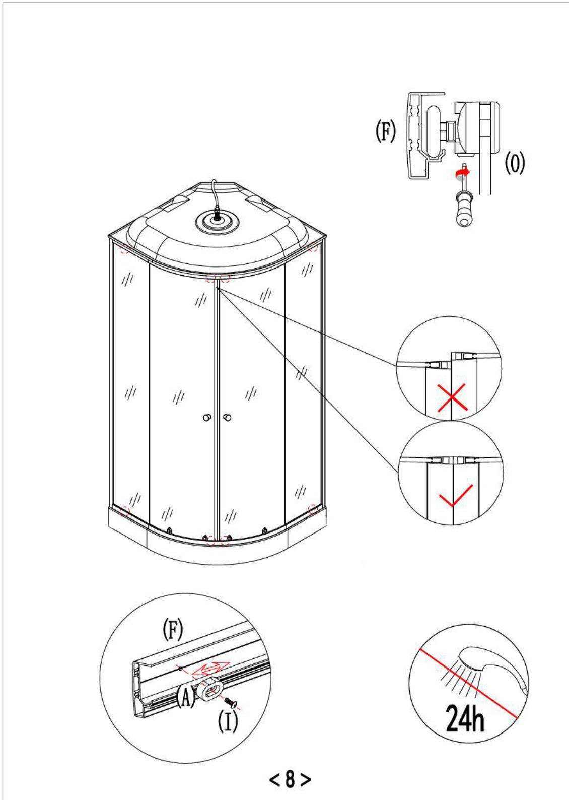
Принцип сборки душевой кабины бессиликоновый, но, в случае необходимости, стыки обработайте санитарным сантехническим герметиком.
