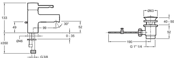
Спецификация продукта: Однорычажный смеситель. E37301. Коллекция: CUFF. Вес: 1,3 кг. Тип установки: 1 отверстие. Расход воды: 5 л/мин. Высота под изливом: 133 мм. Расстояние между центром излива и центральной осью корпуса: 99 мм. Подключение: С гибкой подводкой. Механизм: Керамический картридж. Боковой рычаг донного клапана. Донный клапан.
