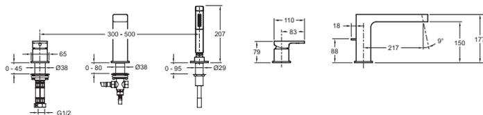
Спецификация продукта: Смеситель для ванны/душа на три отверстия, устанавливаемый на деку. E37337. Коллекция: STRAYT. Вес: 6,4 кг. Высота под изливом: 177 мм. Расстояние между центром излива и центральной осью корпуса: 217 мм. Механизм: Керамический картридж. Подводка для душа, нержавеющей сталь 1.80 см.
