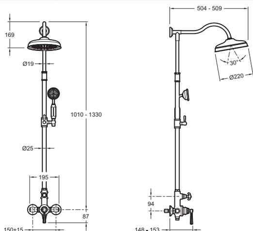
Спецификация продукта : Душевая колонна. E24311. Коллекция : CLÉO 1889. МАТЕРИАЛ : N/A. ТИП УСТАНОВКИ : Крепление к стене.
